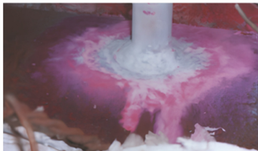
图 4 某温度计套管与主蒸汽母管焊接部位渗透检测结果
