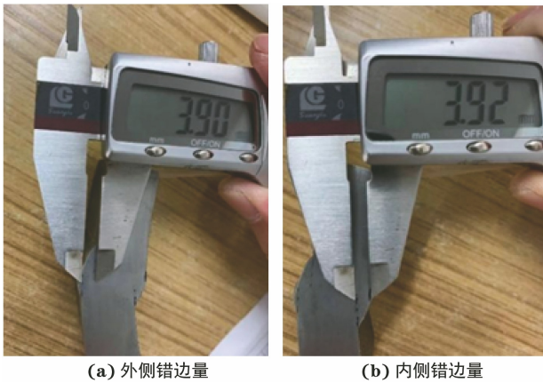
图 11 套筒内外侧纵向焊缝错边量的宏观金相显示
