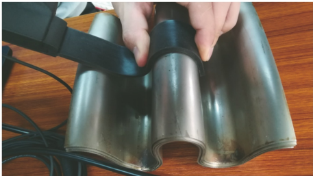
图 8 波纹管阵列涡流检测现场
