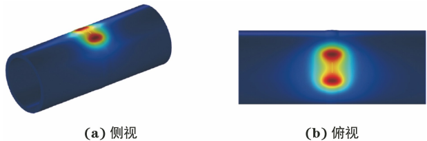
图 2 裂纹附近感应电流分布情况
