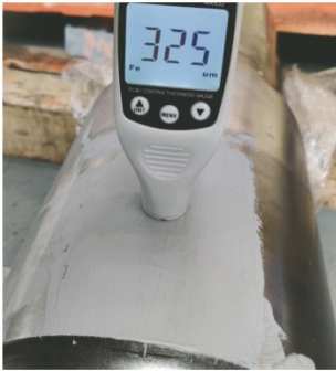
图 11 车轴试件涂漆后测量现场
