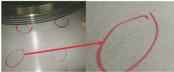
图2 叶轮材料为 FV520B 的磁痕显示
