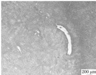
图 8 FV520B 试板电镜观察照片(50×)
