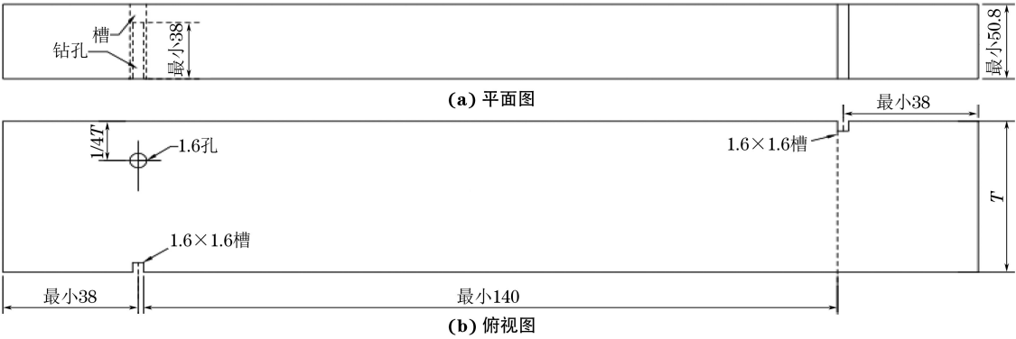
图 12 灵敏度试块结构示意图
