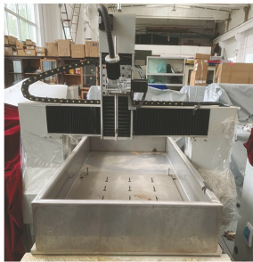
图 9 四轴平动扫描成像系统
