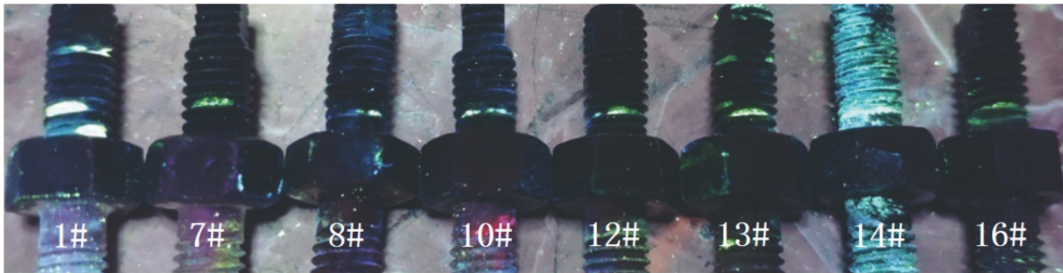
图 4 试件清洗前的荧光渗透检测结果
