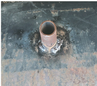
图8 人工制作的焊接式盗油装置实物
