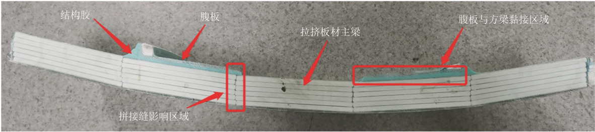
图 13 腹板与拉挤板成型主梁的黏接结构示意
