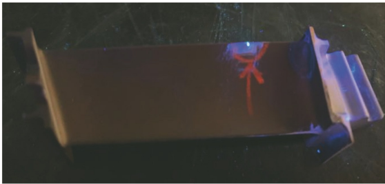
图1 排气边近表面冷隔缺陷的荧光显示
