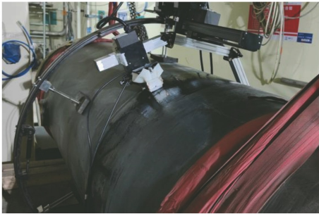
图 7 扫查器弯管适应性测试现场
