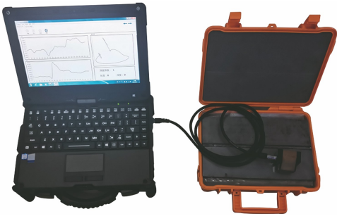
图 3 LKACFM-X1 型交流电磁场检测仪实物
