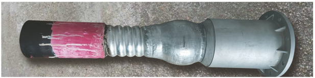
图 2 高压电缆铅封实物
