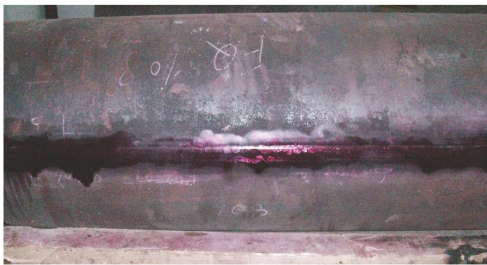
图 2 渗透剂污染示例
