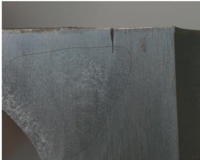
图 8 A0694-2 焊口金相检验结果
