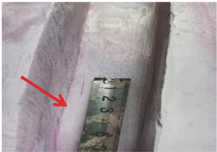
图 11 管道 2 返修打磨后表面的渗透检测结果
