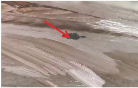
图 13 管道 3 返修打磨后的缺陷照片
