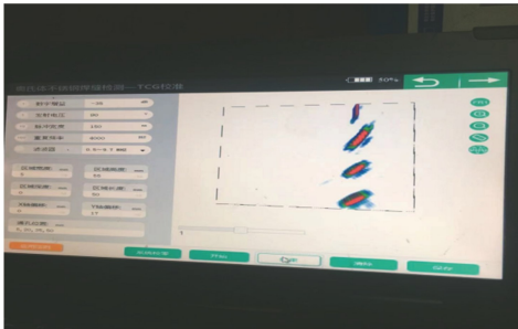
图 4 校准后有效区域的成像结果
