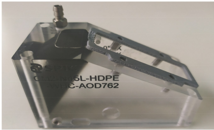
图 8 相控阵探头水楔块外观
