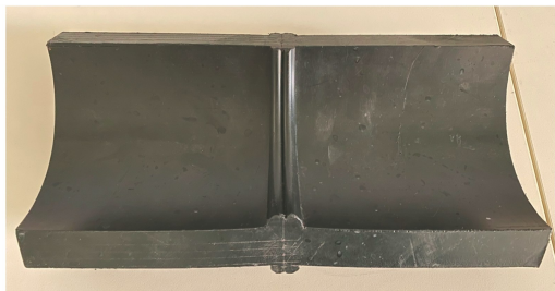
图6 外径为 10 inch 的热熔接头参考试块外观
