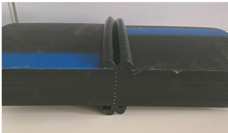
图7 外径为 32 inch 的热熔接头参考试块外观
