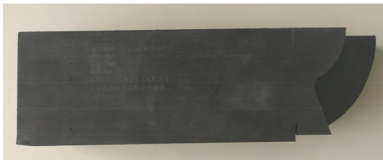
图5 HDPE管道标准试块外观
