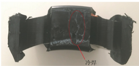
图 3 热熔接头冷焊缺陷外观
