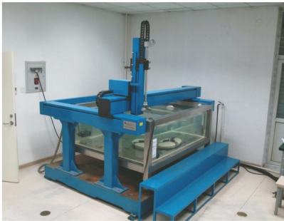
图 1 水浸超声检测系统外观
