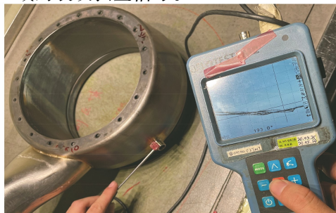
图 7 非裂纹区域的扫查信号
