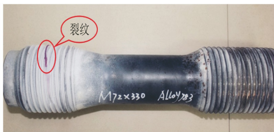
图 8 Inconel 783 螺栓丝扣处裂纹显示
