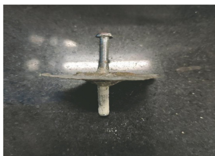
图4 17号试验点拉拔结果
