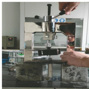
图5 套筒内灌浆料拔出试验现场
