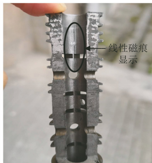
图 2 对切后阀套的磁粉检测结果
