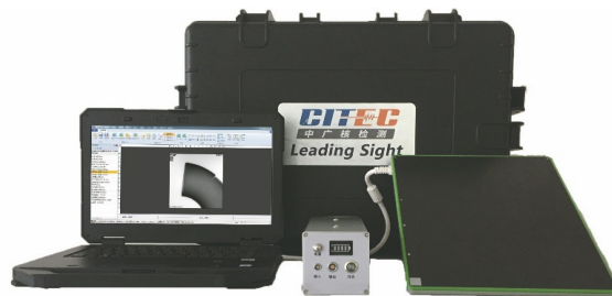
图 1 Leading Sight 型数字射线成像系统
