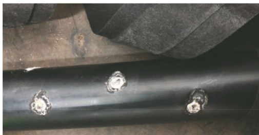
图 1 故障电缆阻水缓冲层烧蚀形貌
