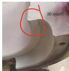
图 2 显像 30 min 时的可疑显示
