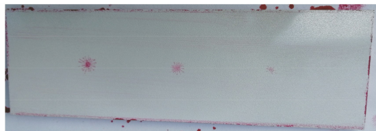
图 3 B 型灵敏度试块显示
