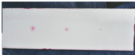
图5 改进工艺后的B型灵敏度试块显示
