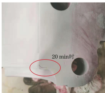
图4 改进工艺后显像20 min时的相关显示
