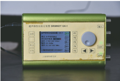
图 6 SRIMNDT GX-1 型校准装置实物图片
