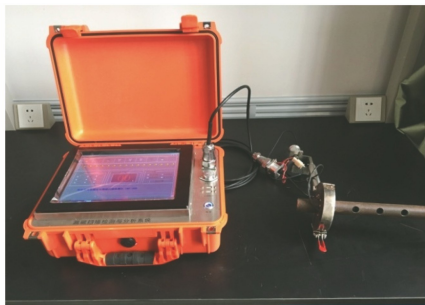
图 13 短接小径管漏磁检测试验系统
