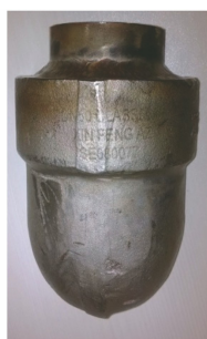
图2 插接焊缝外观型式
