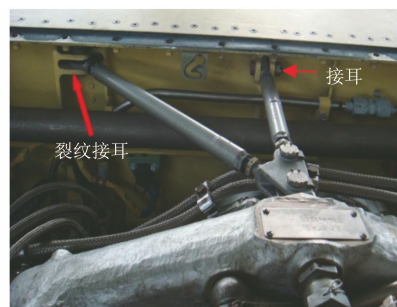
图1 外置机匣接耳安装状态
