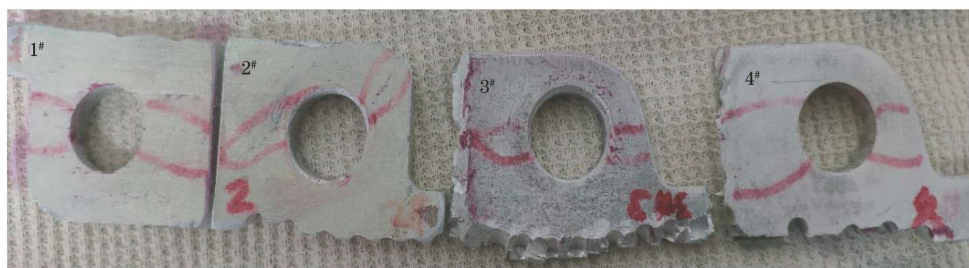
图2 机匣接耳着色检测结果
