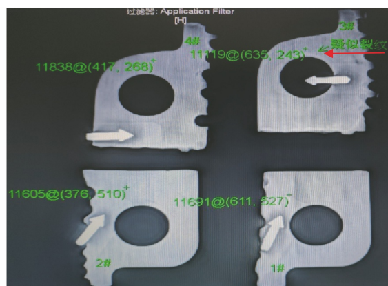
图6 机匣接耳DR检测结果
