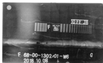
(a) DN 250 mm×8 mm管道的根部内凹缺陷
