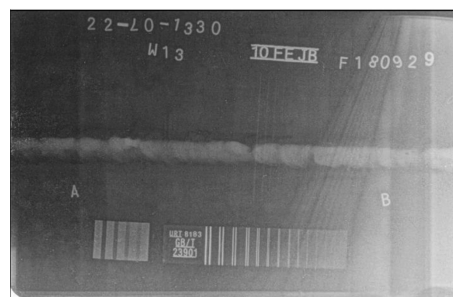
图10 带料管道DN 200 mm×6 mm的 \gamma 射线CR检测结果
