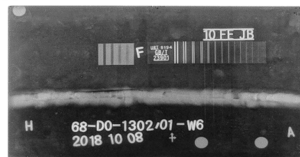
(d) DN 250 mm×8 mm管道的坡口熔合缺陷
