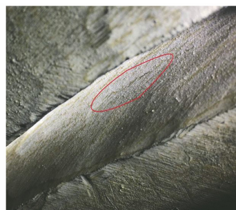
图2 B6接头1 # 裂纹形貌
