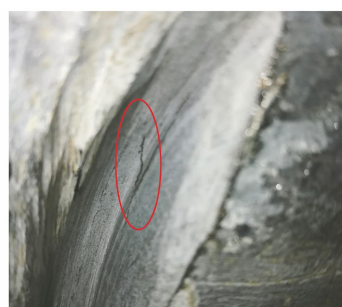
图3 B6接头2 # 裂纹形貌
