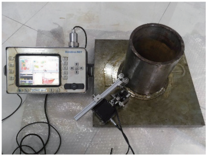
图 12 插入式接管角焊缝扫查现场
