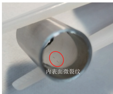
图6 纵伤管材缺陷宏观图片
