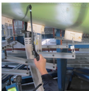
图1 超声泄漏检测仪对某飞机后机身实时检测现场
