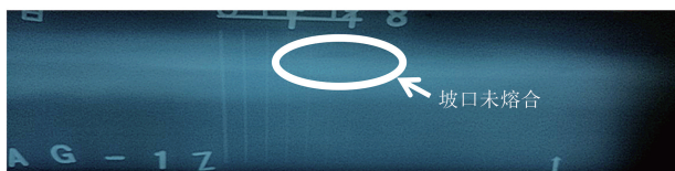
图3 球罐超标缺陷部位的射线底片
