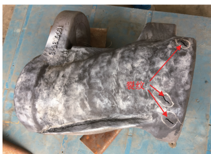
图 3 某裙阀的磁粉检测结果
