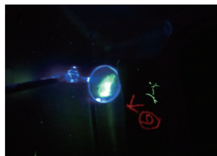
图 14 耳片背后缺陷显示(静电喷涂法)
