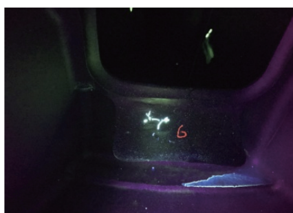
图 9 耳片背后缺陷显示(浸渍法)
