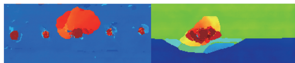
(a) 层板钉孔边分层缺陷和T型加筋结构冲击损伤超声C扫描图像
