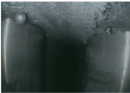
图 5 管板上残留喷丸颗粒照片
