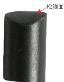
图 11 加工后的磁芯( \phi 4\ \text{mm} )
