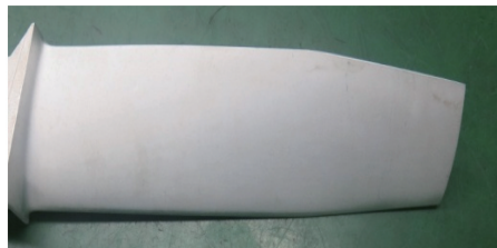
图6 二次除氧化膜后叶片在黑光下的荧光背景
