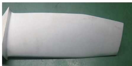
图5 二次除氧化膜后叶片在白光下的表面状态
