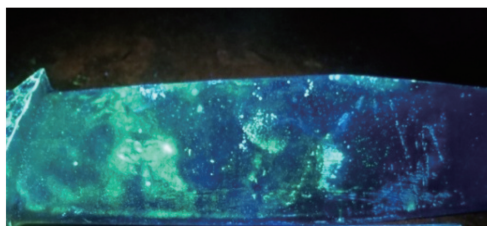
图4 一次重新除氧化膜后叶片在黑光下的荧光背景
