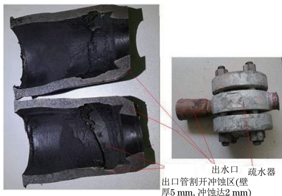
图3 现场减薄管件实物图片
