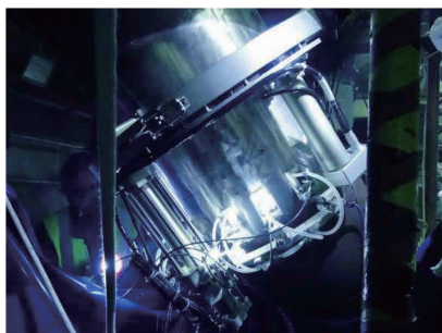
图5 不锈钢管道焊缝超声检测现场
