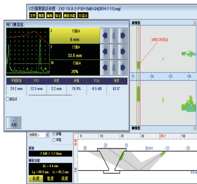
(c) 3 # 坡口未熔合检测结果
