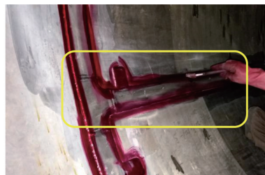
(a) 覆层盖板侧刷涂渗透剂
