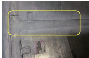
(b) 覆层盖板侧喷涂显像剂
