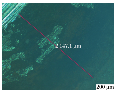
图9 图8中腐蚀位置的剖面金相图像(50倍)
