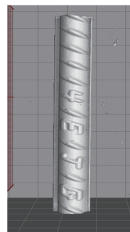
(b) 钢筋未腐蚀三维CT图
