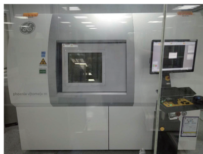
图2 试验用工业CT设备实物图片
