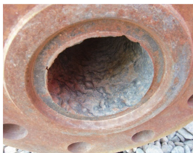
图1 阀门密封面、通道腐蚀形貌
