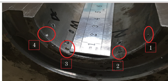
图7 阀门法兰密封面缺陷位置
