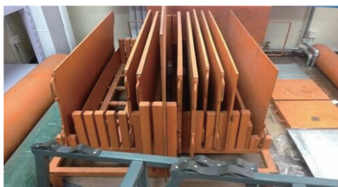
图 11 漏磁检测试件实物图
