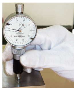
图 6 微孔测量仪测量孔径示意
